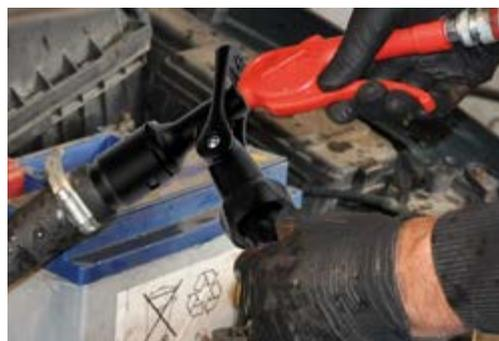
O ar comprimido aumenta a pressão da água em comparação com o fornecimento principal de água. O **JWL Jet Flusher** está equipado com válvulas de controle variáveis tanto para o fluxo de ar como para o fluxo de água. Isso permite que o fornecimento de água seja fechado diretamente no **Jet Flusher** ao fazer uma pausa ou ao trocar o bico.
