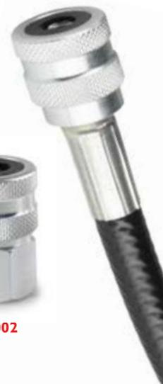
16 Bar (Máx) -20°C a +60°C 0,023 kg (ligação da Mangueira) 0,026 kg (rosca interna) 300 l/min com queda de pressão de 0,6 bar. 650 l/min em fluxo livre
